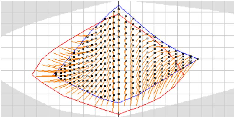
Esta es una representación esquemática de cómo funciona el propósito de conversión de saturación reajustando los colores (imagen original: vídeo quicktime © 1996-1998 Candela Ltd.). Debes tener activada la opción "animación" web en el navegador para verlo bien.
